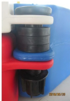
13.5 ล็อคสกรูและพินยาวทุกตัวประแจน็อตสแตนเลส วิธีการใส่แหวนรองเพื่อปรับระดับของ Ramp ให้เท่ากัน ดูได้จากรูปด้านล่าง
