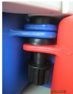
13.5 ล็อคสกรูและพินยาวทุกตัวประแจน็อตสแตนเลส วิธีการใส่แหวนรองเพื่อปรับระดับของ Ramp ให้เท่ากัน ดูได้จากรูปด้านล่าง
